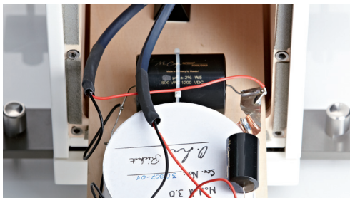
DIE WEICHE FÜR DEN TIEFMITTELTÖNER WURDE MIT BESTEN BAUTEILE FREIVERDRAHTET AUFGEBAUT.
