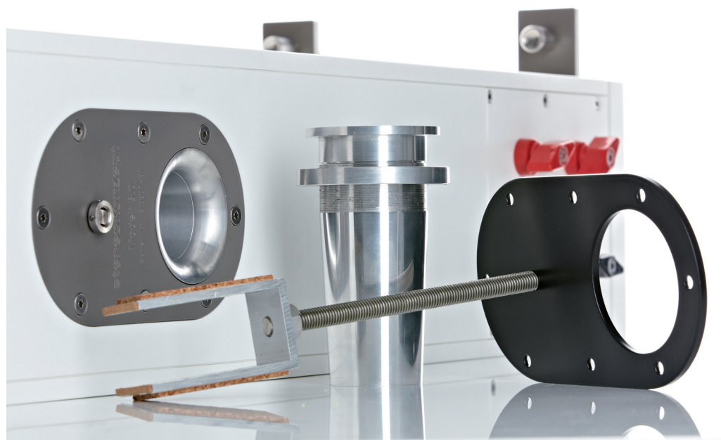
DER FEIN GEDREHTE REFLEXKANAL LÄUFT KONISCH ZU. ER ENDET IN EINER EDELSTAHLPLATTE, DIE AUCH ALS TYPENSCHILD UND GEGENLAGER FÜR DIE VERSPANNVORRICHTUNG FÜR DEN TIEFMITTELTÖNER DIENST. RESONANZANFÄLLIGE FLÄCHEN WERDEN MIT KORK BEDÄMPFT
